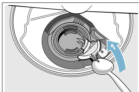
6. Flügelrad auf Fremdkörper prüfen und diese gegebenenfalls entfernen.
