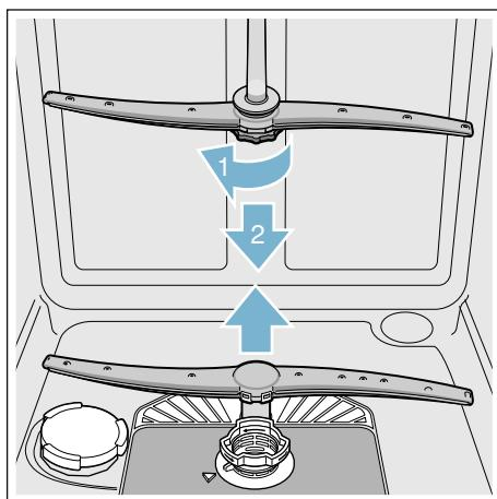
4. Sprüharme unter fließendem Wasser reinigen.
