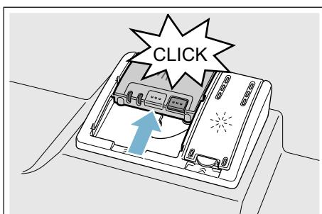
Die Reinigerkammer öffnet sich programmababhängig automatisch zum optimalen Zeitpunkt. Der Pulver- oder Flüssigreiniger verteilt sich im Gerät und wird aufgelöst, der Tab fällt in die Tab-Auffangschale und löst sich dort dosiert auf.
