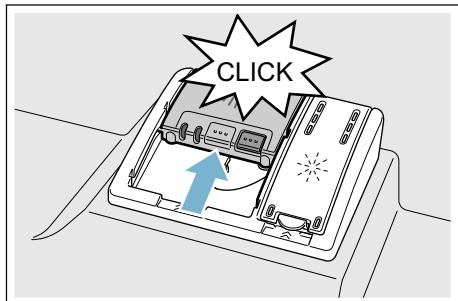
Compartimentul pentru detergent se deschide automat în funcție de program, la momentul optim. Detergentul sub formă de praf sau lichid se distribuie în aparat și se dizolvă, tabletă cade în tăvita de captare a tabletelor și se dizolvă acolo respectând dozarea.
