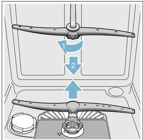
4. Curătați ambele brațe de pulverizare sub jet de apă.
