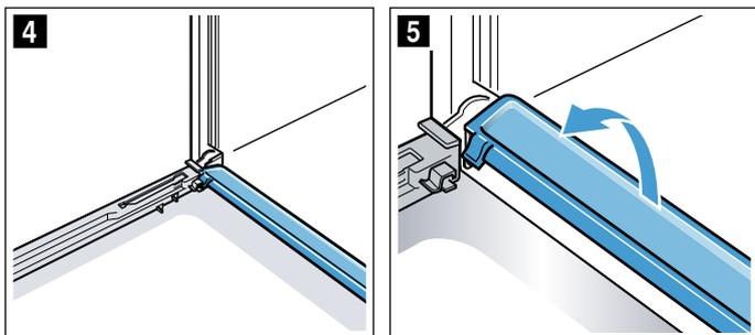
Nettoyez les vitres avec un nettoyant pour vitres et un chiffon doux. Essuyez la baguette de condensation avec un chiffon et du produit de nettoyage chaud.
