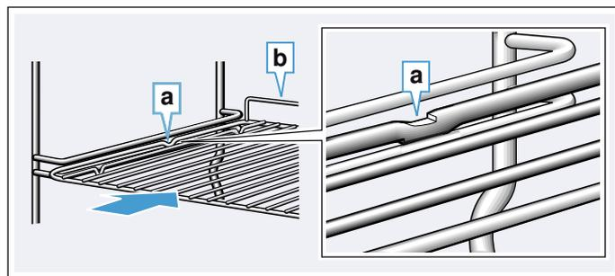
En enfournant le panier vapeur, veillez à ce que le taquet d'arrêt **c** se situe en arrière et soit orienté vers le bas.
