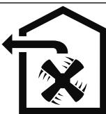
Aerul nu trebuie să fie evacuat printr-un coș care este utilizat pentru evacuarea gazelor arse de la aparat, gazului sau altor carburanți (nu se aplică pentru aparatelor la care se utilizează tehnologia de recirculare a aerului).
