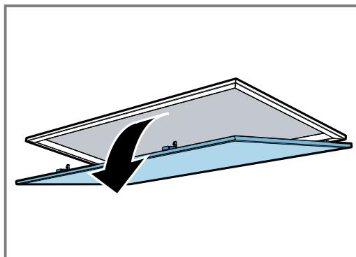
2. Die Verriegelungen an den Fettfiltern öffnen.
