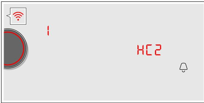
6. Ξεκινήστε την εφαρμογή (App) στην κινητή τερματική συσκευή και ακολουθήστε τις υποδείξεις για τη χειροκίνητη σύνδεση στο δίκτυο. Η διαδικασία σύνδεσης έχει ολοκληρωθεί, όταν στην ένδειξη των εστιών μαγειρέματος εμφανιστεί η τιμή **0**.
