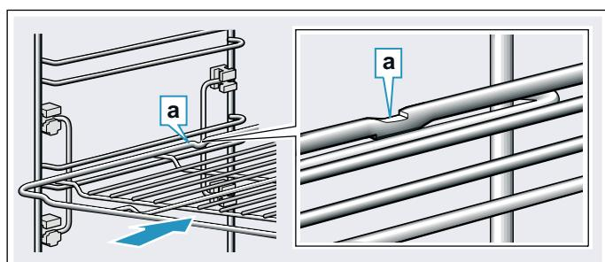
Al introducir las bandejas, asegurarse de que la ranura **a** se encuentra en la parte trasera y señala hacia abajo. El desnivel de los accesorios **b** debe señalizar por delante hacia la puerta del aparato.
