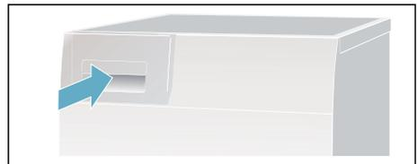
**Nota:** El filtro ubicado en el recipiente de agua de condensación filtra el agua de condensación que se utiliza para la limpieza automática de la secadora. El filtro se limpia al vaciar el agua de condensación. No obstante, es necesario comprobar periódicamente el filtro y eliminar los posibles residuos que se hayan podido acumular. Ver → *Página 37.*
