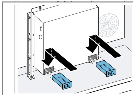
14. Die Kabel am Lüfterkasten einstecken.
