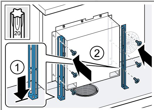
10. Am Schrankboden die Schienen festschrauben.
