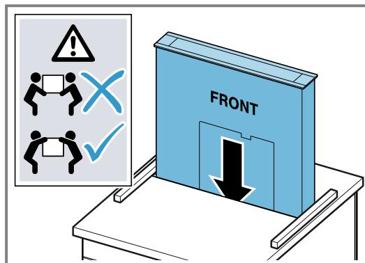
Insérez l'appareil uniformément pour qu'il ne se bloque pas.
