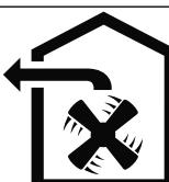
L'aria non deve essere deviata in un cammino che viene utilizzato per lo scarico di gas di apparecchi che bruciano gas o altri combustibili (questo non vale per apparecchi a ricircolo d'aria).
