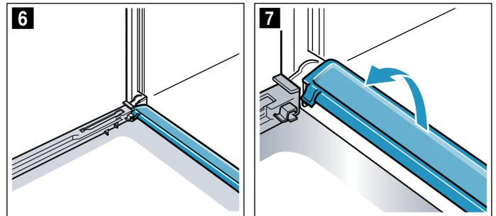
Per la pulizia dei pannelli utilizzare un detergente per i vetri e un panno morbido. Lavare la barra per la condensa con un panno e una soluzione di lavaggio calda.
