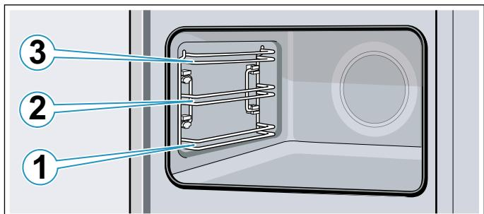
In den Einschubhöhen 1, 2, und 3 das Zubehör immer zwischen die beiden Führungsstäbe einer Einschuhhöhe schieben.
