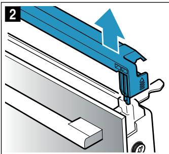
**Hinweis:** Den Edelstahleinleger in der Abdeckung mit Edelstahlreiniger reinigen. Die restliche Türabdeckung mit Spüllauge und einem weichen Tuch reinigen.
