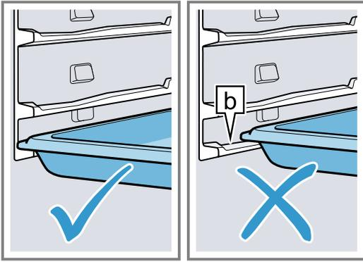
3. Den Dampfbehälter mittig greifen und einschieben.
