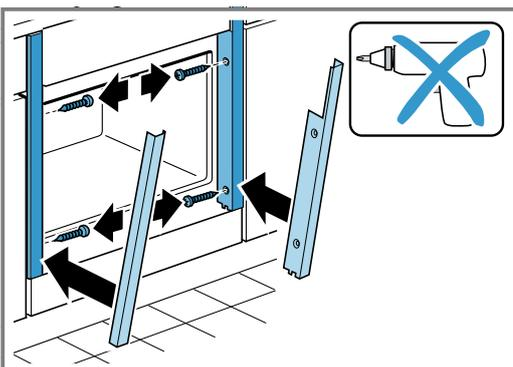
8. Bei Bedarf den Spalt zwischen Gerätetür und den seitlichen Blenden über die obere Schraube links und rechts anpassen.
