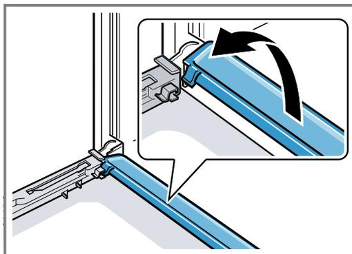
7. Die Türscheiben mit Glasreiniger und einem weichen Tuch reinigen. Die Kondensatleiste mit einem Tuch und heißer Spüllauge reinigen.
