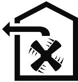
Poistoilmaa ei saa johtaa hormiin, jota käytetään kaasua tai muita poltoaineita polttavien laitteiden pakokaasun poistoon (tämä ei koske kiertoilmalaitteita).
