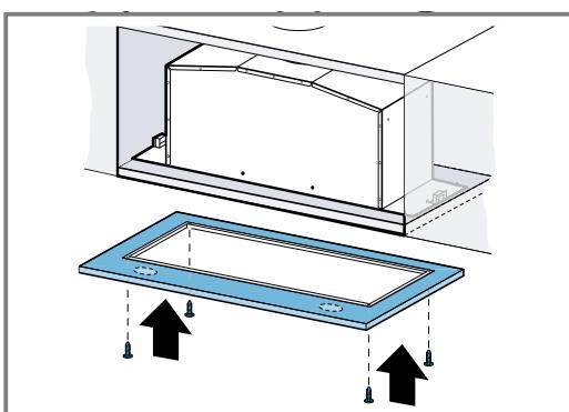
4. Fixați cu șuruburi cadrul la aparat.
