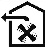
Aerul nu trebuie să fie evacuat printr-un coș care este utilizat pentru evacuarea gazelor arse de la aparete, gazului sau altor carburanți (nu se aplică pentru apărantele la care se utilizează tehnologia de recirculare a aerului).
