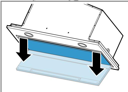
**3.** Отвийте шарнирния фиксатор и отстранете капака на филтъра.
