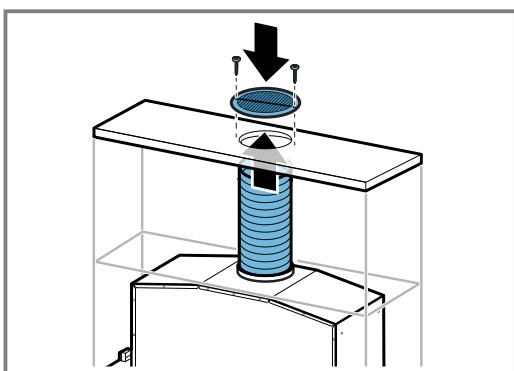
3. Fixați cu șuruburi grilajul de evacuare a aerului pe mobilierul de încorporare.
