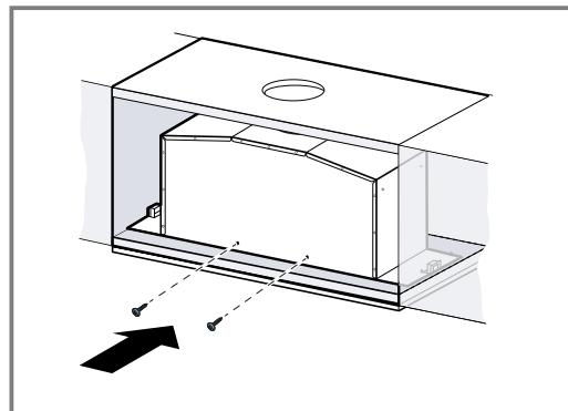
În cazul în care șuruburile nu sunt accesibile din exterior, acestea pot fi montate și din interior.
