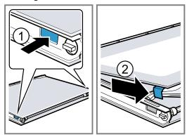
Die Zwischenscheibe im Bereich a leicht nach unten drücken und die Halterung b vorsichtig anheben, bis sie sich herausziehen lässt.
