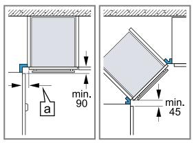
Damit die Gerätetür geöffnet werden kann, beim Eckeinbau die Mindestmaße berücksichtigen. Das Maß a ist abhängig von der Dicke der Möbelfront und dem Griff.
