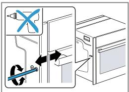
Mit dem Uhrzeigersinn: Spalt vergrößern Gegen den Uhrzeigersinn: Spalt verkleinern
