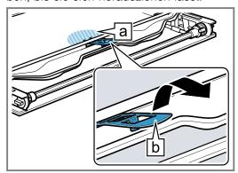
5. Die Zwischenscheibe von unten anheben ① und in Pfeilrichtung herausnehmen 2.
