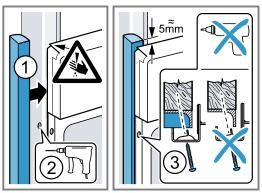
**9.** Die Gerätetür etwas öffnen, die Blenden anlegen und zuerst oben, dann unten festschrauben.
