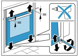
Mit dem Uhrzeigersinn: Spalt verkleinern Gegen den Uhrzeigersinn: Spalt vergrößern
