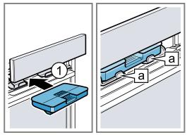
Die Bedienblende langsam nach unten schieben, dann nach hinten drücken, bis die Bedienblende vollständig geschlossen ist.
