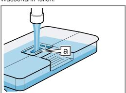
Den gefüllten Wassertank einsetzen ①. Dabei darauf achten, dass der Wassertank an den Halterungen a einrastet.
