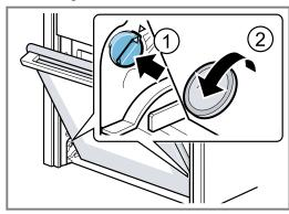
Die Gerätetür ein Stück weit öffnen, bis ein leises Klickgeräusch hörbar ist und die Gerätetür schließen
