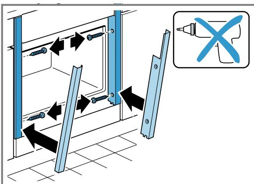
8. Bei Bedarf den Spalt zwischen Gerätetür und den seitlichen Blenden über die obere Schraube links und rechts anpassen.
