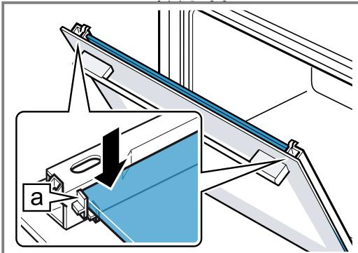
5. Die Gerätetür öffnen und Türdichtung einhängen.
