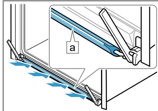
2. Die Gerätetür gerade auf die beiden Scharniere schieben ①. Die Gerätetür bis zum Anschlag schieben.
