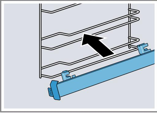
2. Die Halterung [a] hinten zwischen dem unteren und oberen Stab einführen.
