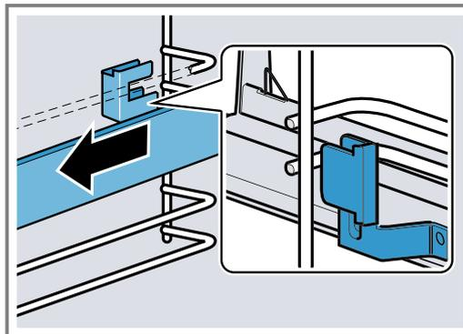
4. Die Auszugsschiene entfernen.
