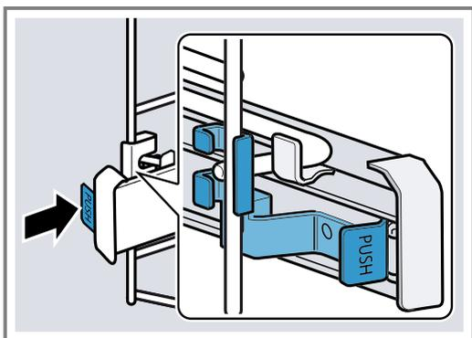
2. **PUSH** gedrückt halten ① und die Schiene nach außen schwenken ②.
