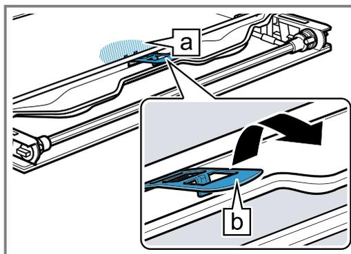
5. Die Zwischenscheibe von unten anheben ① und in Pfeilrichtung herausnehmen ②.
