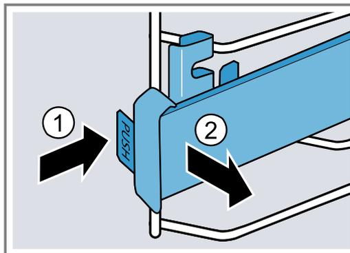
3. Die Schiene nach vorn ziehen, bis die Halterung hinten ausgehängt ist.
