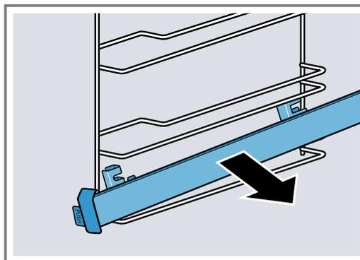
5. Die Auszugsschiene reinigen.
