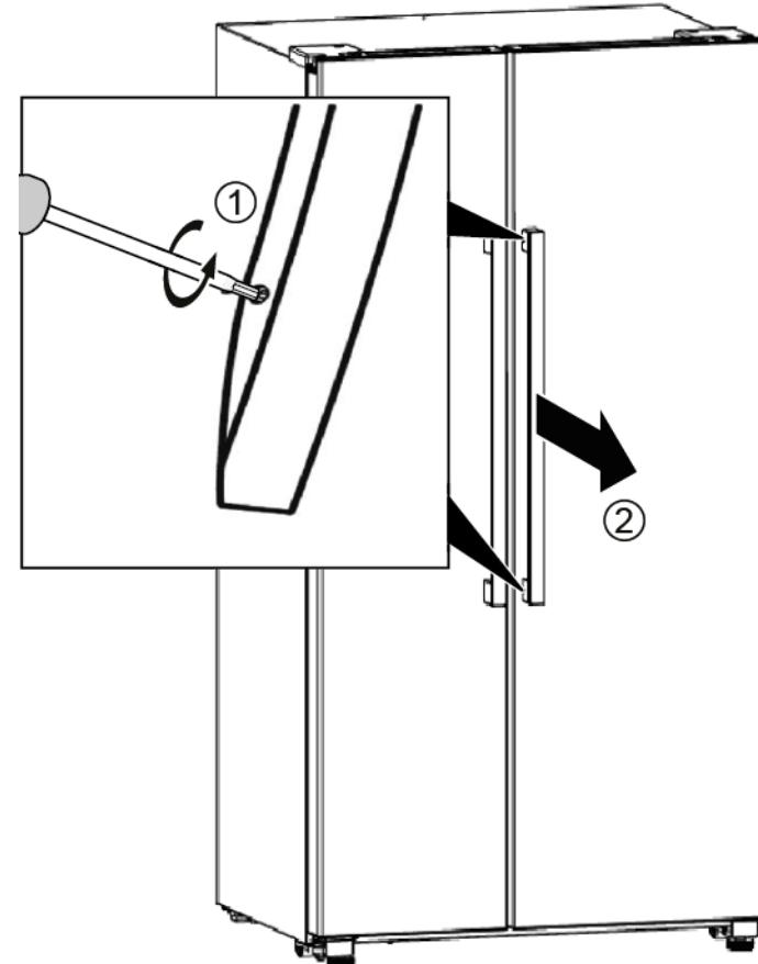
➡ Ukse käepide on eemaldatud.
