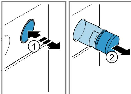
2. Appuyez sur le couvercle du réservoir d'eau ① et ouvrez-le ②.
