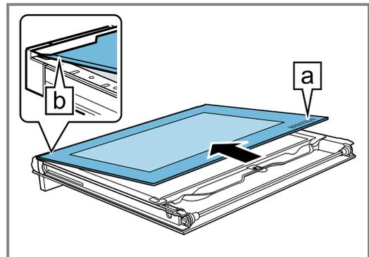
7. Soulever la vitre intérieure avec précaution en biais vers le haut et l'accrocher dans la fixation **a**.
