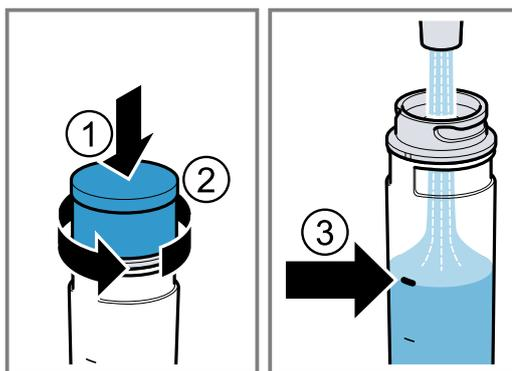
4. Appuyez sur le couvercle du réservoir d'eau ① et fermez-le ②.
