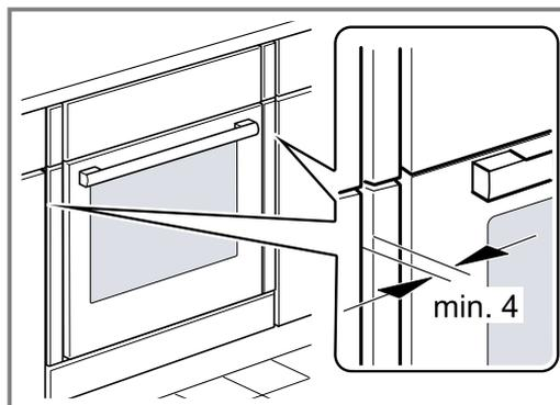
Une fente d'aération d'au moins 4 mm est nécessaire entre l'appareil et la façade des meubles adjacents.
