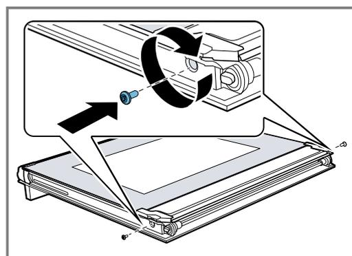
9. Revissez les deux vis à gauche et à droite de la porte de l'appareil.
