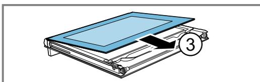
5. Appuyez vers le bas sur la vitre intermédiaire dans la zone [a] soulevez avec précaution la fixation [b] jusqu'à ce qu'elle puisse être retirée.
