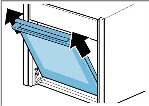
7. Posez la porte de l'appareil sur une surface plane, souple et propre.
