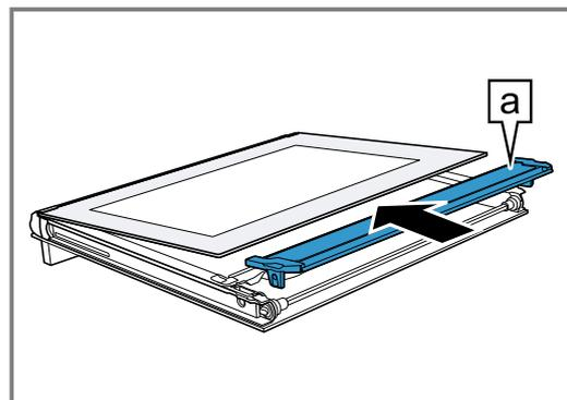
8. Inserire il pannello interno con il supporto **a** nell'apertura.
