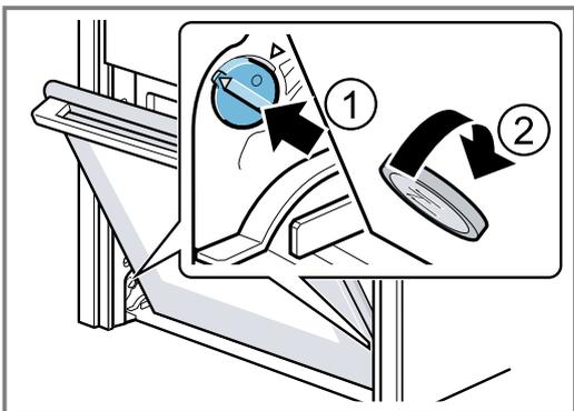
Dispositivo di bloccaggio sul lato sinistro non fissato
