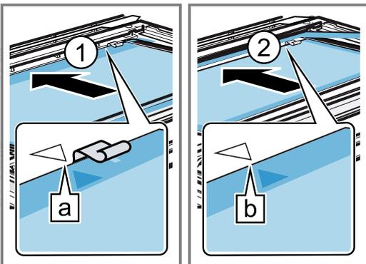
La freccia sul pannello intermedio deve coincidere con la freccia sulla cornice **b**.
