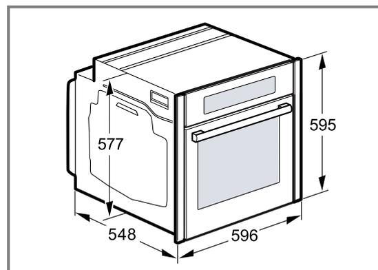
**24.3 Einbau unter einer Arbeitsplatte**
