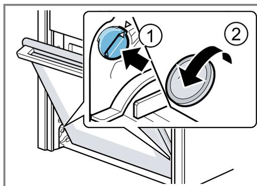
4. Die Gerätetür ein Stück weit öffnen, bis ein leises Klickgeräusch hörbar ist und die Gerätetür schließen.
