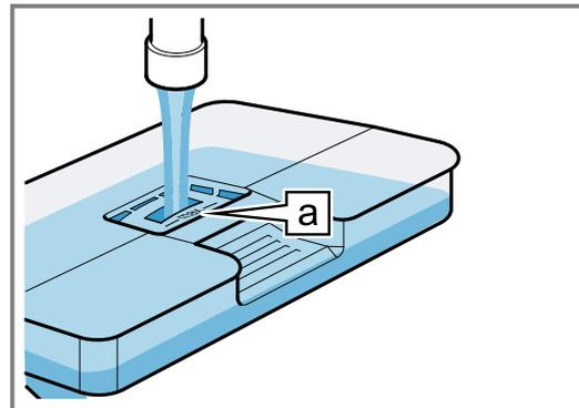
6. Den gefüllten Wassertank einsetzen ①. Dabei darauf achten, dass der Wassertank an den Halterungen
