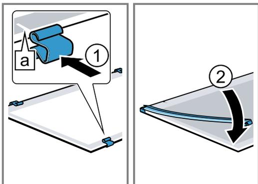
3. Die Zwischenscheibe mit Abstandshalter und Dichtungen in Pfeilrichtung einsetzen **1**.
