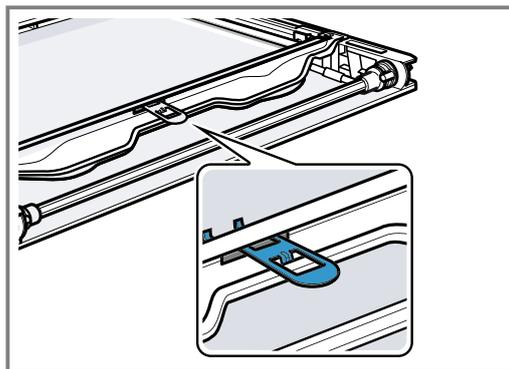
6. Die Innenscheibe so auf die Gerätetür legen, dass die Nummer **a** rechts unten lesbar ist. Die Innenscheibe schräg nach hinten in die Befestigungsschiene **b** einsetzen.
