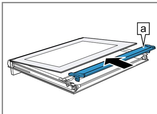
8. Die Innenscheibe mit der Halterung
