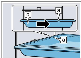
3. Introducir completamente el accesorio de tal forma que no toque la puerta del aparato.
