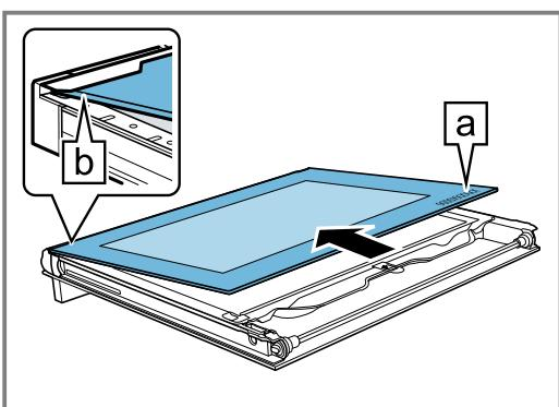
7. Levantar el cristal interior con cuidado, hacia arriba y en diagonal, y colocar la sujeción **a**.
