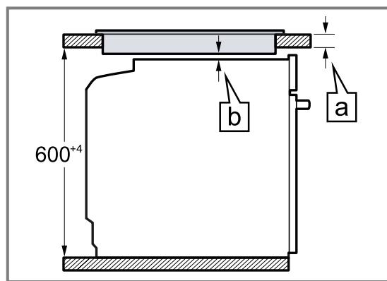
En función de la separación mínima requerida **b** se determina el grosor mínimo de la encimera **a**.
