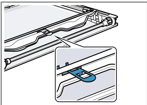
6. Colocar el cristal interior sobre la puerta del aparato de manera que el número **a** que aparece en la parte inferior derecha sea legible. Colocar el cristal interior en posición inclinada hacia atrás en el riel de fijación **b**.
