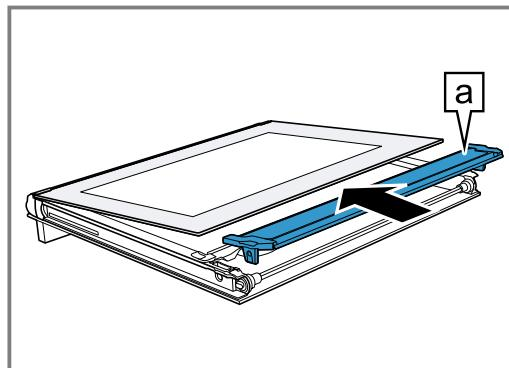
8. Colocar el cristal interior con la sujeción **a** en la abertura.
