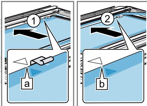
La flecha sobre el cristal intermedio debe coincidir con la flecha sobre el marco **b**.
