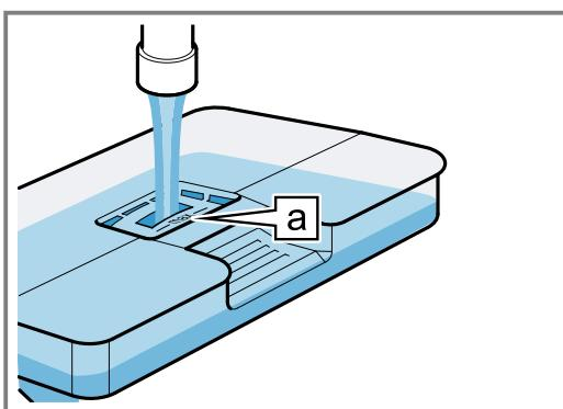
6. Colocar el depósito de agua lleno ①. Al hacerlo, asegurarse de que el depósito encaje en las sujetaciones a.
