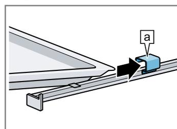
5. Introducir completamente el accesorio de tal forma que no toque la puerta del aparato.
