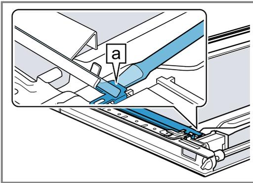
6. Levantar el reflector [b] con el destornillador ① hasta que se suelte; después, levantar y tirar ②.
