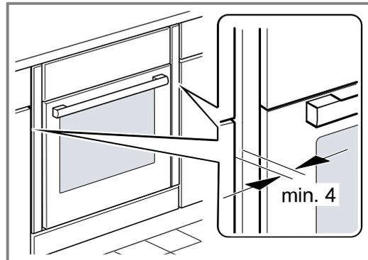
Debe dejarse una separación para ventilación de 4 mm como mínimo entre el aparato y los frontales de los muebles adyacentes.
