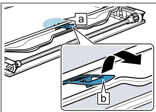
9. Levantar el primer y el segundo cristal intermedio desde abajo ① y extraerlos en la dirección de la flecha ②.
