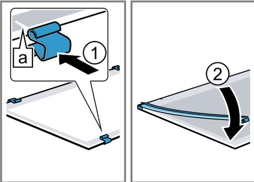
3. Colocar el cristal intermedio con los distanciadores y las juntas en la dirección de la flecha ①. La flecha sobre el cristal intermedio debe coincidir con la flecha sobre el marco **a**.
