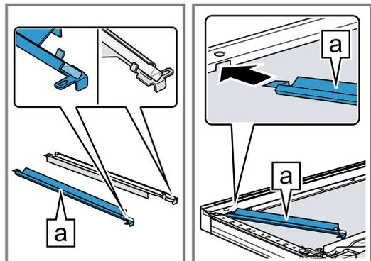
7. Colocar el reflector **a** y encajarlo en el hueco **b**.
