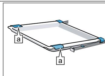
Rost Den Rost mit der offenen Seite zur Gerätetür und der Krümmung nach unten einschieben.
