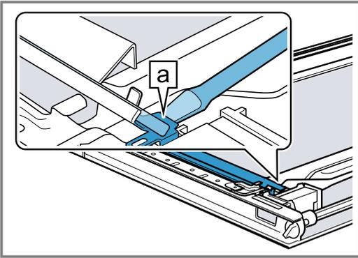
5. Den Reflektor **b** mit dem Schraubendreher anheben **1**, bis dieser sich löst, danach anheben und herausziehen **2**.
