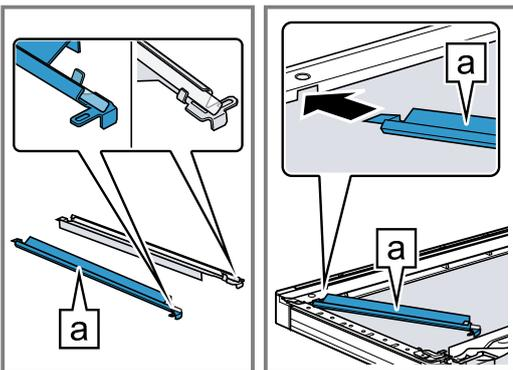
4. Den Reflektor **a** einsetzen und in Spalte **b** einrasten.
