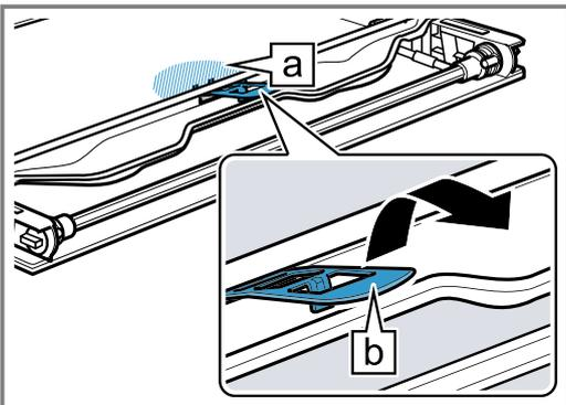
8. Die Zwischenscheibe von unten anheben **1** und in Pfeilrichtung herausnehmen **2**.
