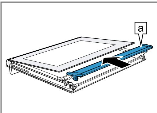
12. Colocar el cristal interior con la sujeción **a** en la abertura.
