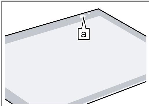
**2.** Comprobar la colocación de los 4 distanciadores y de las 2 juntas.
