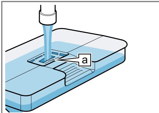
6. Colocar el depósito de agua lleno ①. Al hacerlo, asegurarse de que el depósito encaje en las sujeciones
