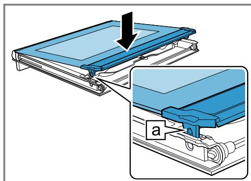
13. Enroscar los dos tornillos a la derecha e izquierda de la puerta del aparato.
