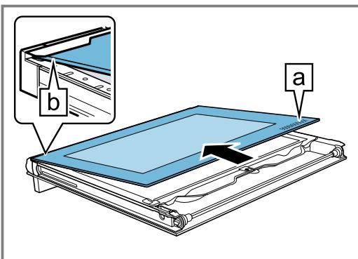
11. Levantar el cristal interior con cuidado, hacia arriba y en diagonal, y colocar la sujeción **a**.
