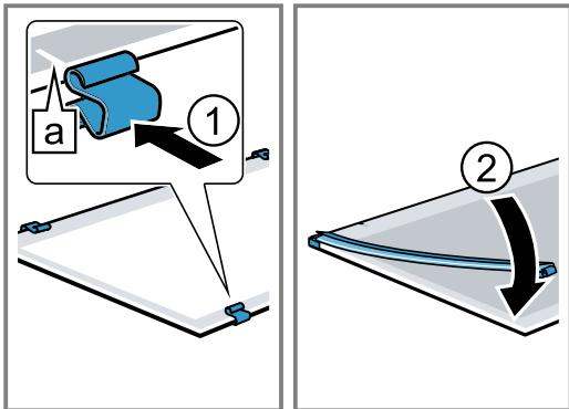
**3.** Colocar el cristal intermedio con los distanciadores y las juntas en la dirección de la flecha ①.
