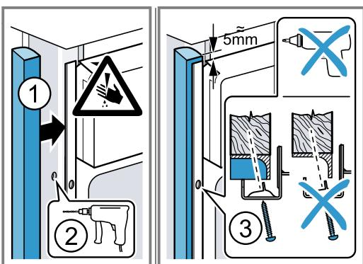
9. Abrir ligeramente la puerta del aparato, colocar las molduras y atornillarlas, primero la moldura de arriba y después la de abajo.
