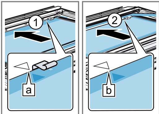
La flecha sobre el cristal intermedio debe coincidir con la flecha sobre el marco **b**.
