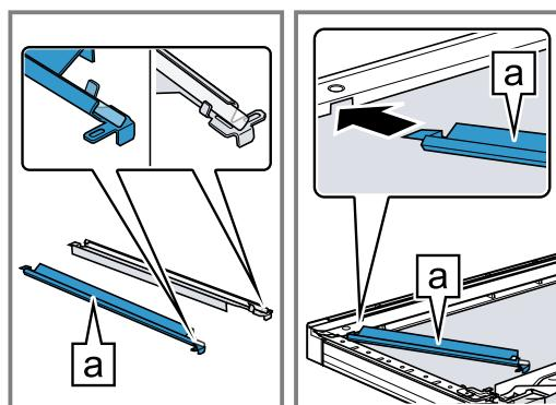
**7.** Colocar el reflector **a** y encollarlo en el hueco **b**.
