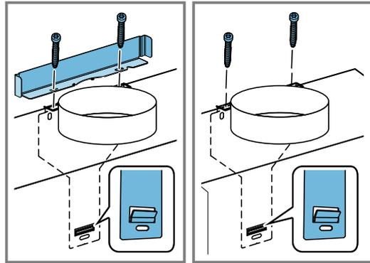
Wenn Sie eine Kaminverblendung montieren, den Winkel einbauen und beim Festziehen der Schrauben festhalten.
