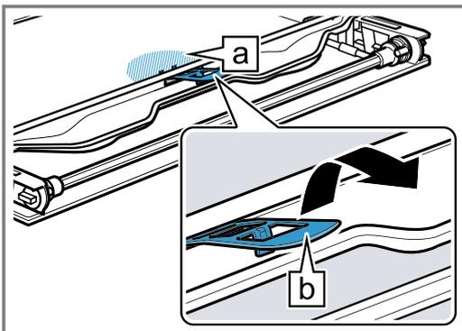
9. Die erste und zweite Zwischenscheibe von unten anheben ① und in Pfeilrichtung herausnehmen ②.
