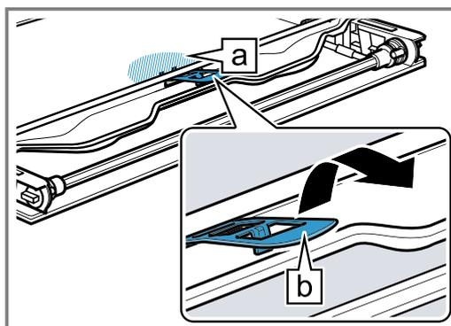
9. Die erste und zweite Zwischenscheibe von unten anheben ① und in Pfeilrichtung herausnehmen ②.
