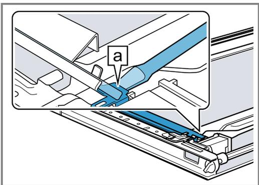
6. Den Reflektor **b** mit dem Schraubendreher anheben ①, bis dieser sich löst, danach anheben und herausziehen ②.
