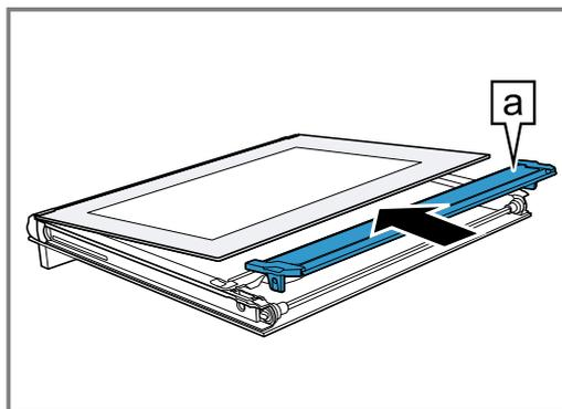
12. Die Innenscheibe mit der Halterung **a** in die Öffnung einsetzen.
