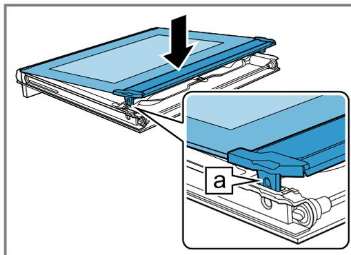
13. Die beiden Schrauben links und rechts an der Gerätetür eindrehen.
