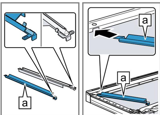
7. Den Reflektor **a** einsetzen und in Spalte **b** einrasten.
