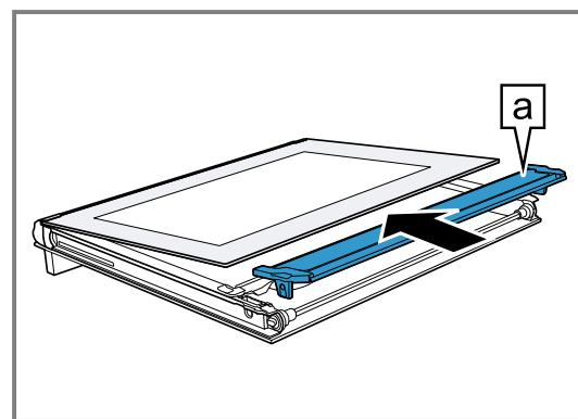
9. Insérer la vitre intérieure avec la fixation **a** dans l'ouverture.
