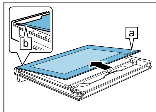
8. Soulever la vitre intérieure avec précaution en biais vers le haut et l'accrocher dans la fixation **a**.
