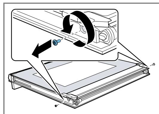
3. Soulever la vitre intérieure avec précaution en biais vers le haut **①** et retirer la **a** fixation **②**.
