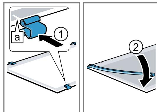
4. Placer la vitre intermédiaire avec les joints et les écarteurs dans le sens de la flèche ①.
