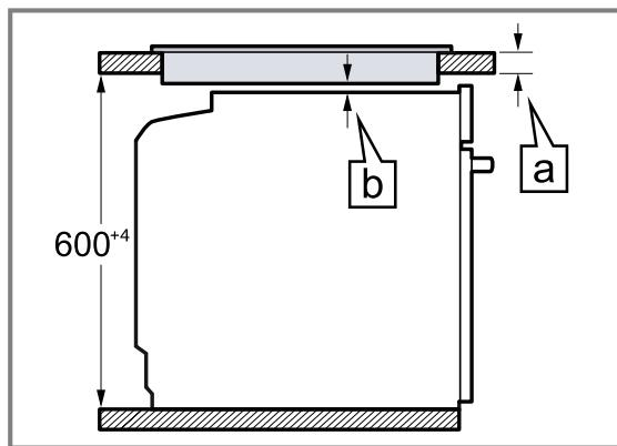
En raison de la distance minimale nécessaire **b** l'épaisseur minimale du plan de travail qui en découle est **a**.
