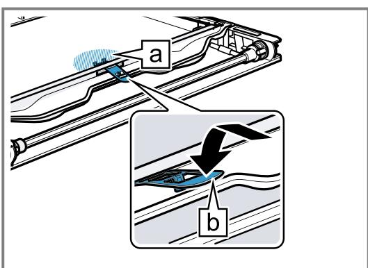
7. Placer la vitre intérieure sur la porte de l'appareil de sorte que le numéro **a** à droite en bas soit lisible. Ins-
