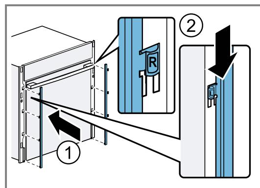
11. Enfichez les bandeaux à gauche et à droite à hauteur des éléments de fixation, jusqu'à ce qu'un clic retienne.
