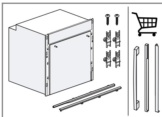
Selon la configuration de l'appareil, différentes poignées et bandeaux sont possibles. Un exemple est représenté sur l'illustration.
