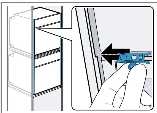
3. Tournez l'élément de fixation vers la gauche ou la droite pour adapter l'orientation des bandeaux.
