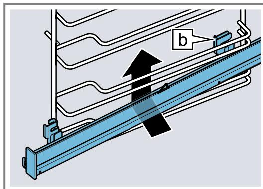
2. Guidez le rail dans le sens de la longueur vers les barres de guidage à l'arrière et poussez les deux supports à chaque fois sur la barre inférieure. Saisissez la barre verticale avec le support arrière **b**.
