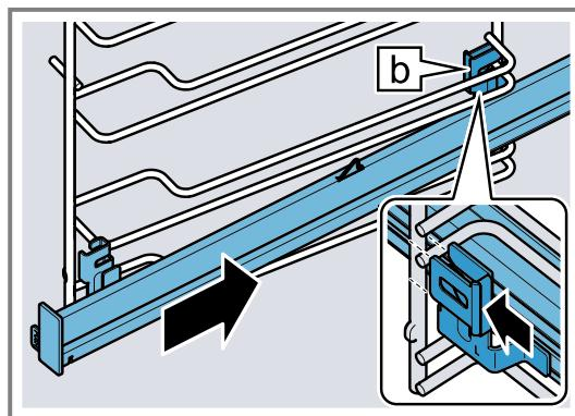
3. Maintenez enfoncé **PUSH** ① et faites pivoter le rail télescopique vers l'intérieur ②, jusqu'à ce que le support **a** soit accroché dans la barre inférieure.
