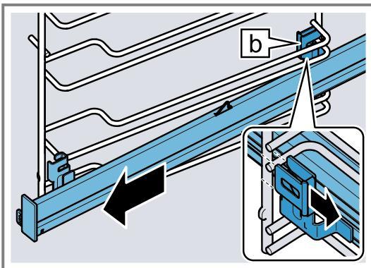
4. Die Auszugsschiene entfernen.
