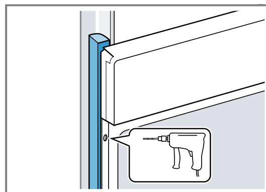
4. Das Gerät mit adäquater Schraube befestigen.
