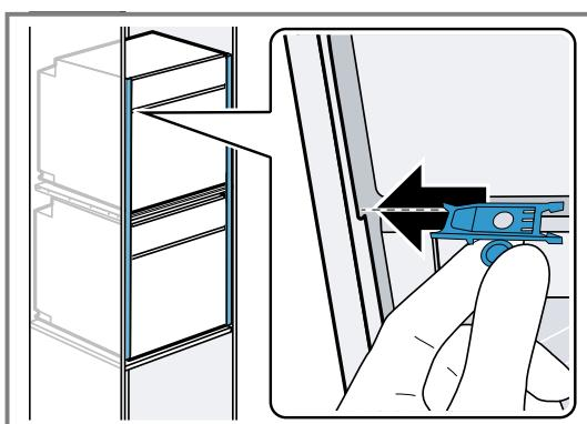
3. Das Befestigungselement nach links oder rechts drehen, um die Ausrichtung der Blenden anzupassen.
