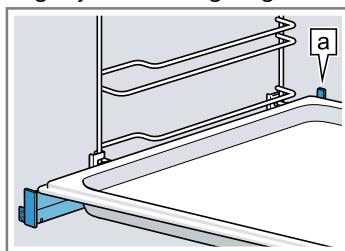
**Hinweis:** Vollständig herausgezogen rasten die Auszugsschienen ein. Die Auszugsschienen mit etwas Druck zurück in den Garraum schieben.
