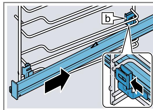
3. **PUSH** gedrückt halten ① und die Auszugsschiene nach innen schwenken ②, bis die Halterung ③ in den unteren Stab einhängt.
