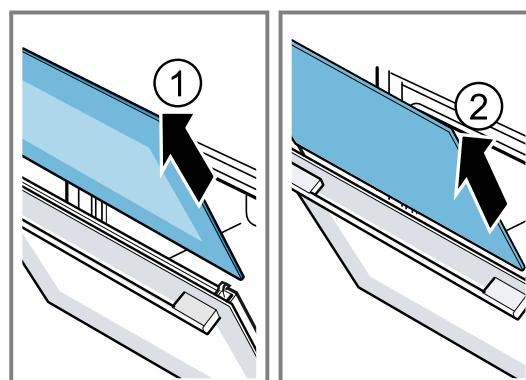
8. Die Gerätetür öffnen und Türdichtung abnehmen.
