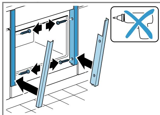
7. Bei Bedarf den Spalt zwischen Gerätetür und den seitlichen Blenden über die obere Schraube links und rechts anpassen.
