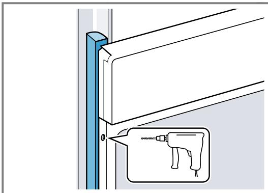
4. Das Gerät mit adäquater Schraube befestigen.
