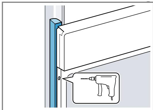
4. Das Gerät mit adäquater Schraube befestigen.
