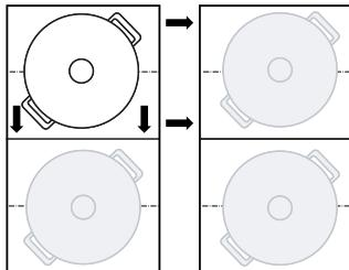
La stoviglia viene riconosciuta e sull'indicatore della nuova area di cottura lampeggiato in modo alternato il livello di potenza precedentemente selezionato e  $\text{L}$ .
