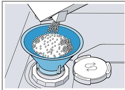
Напълнете резервоара изцяло със специална сол. Водата в резервоара се изтласква и изтича.
