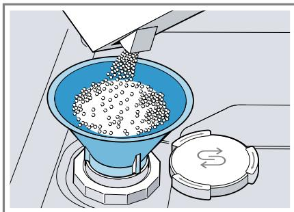
Riempire completamente il serbatoio di sale speciale. L'acqua nel serbatoio trabocca e defluisce.
