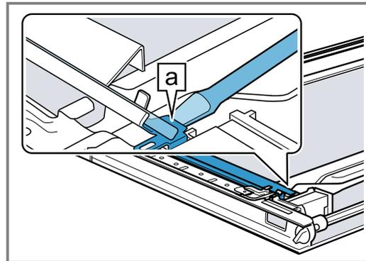
5. Soulevez le réflecteur [b] à l'aide du tournevis ①, jusqu'à ce qu'il se détache, puis soulevez-le et extraitez-le ②.
