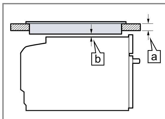
Sulla base della distanza minima necessaria **b** risulta lo spessore minimo del piano di lavoro **a**.
