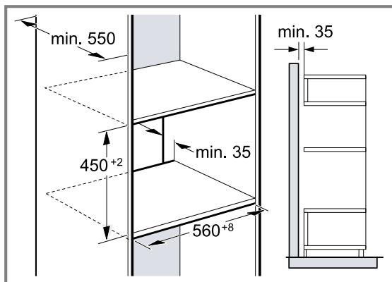
Per la ventilazione degli apparecchi occorre una fessura di ventilazione nei doppifondi.
