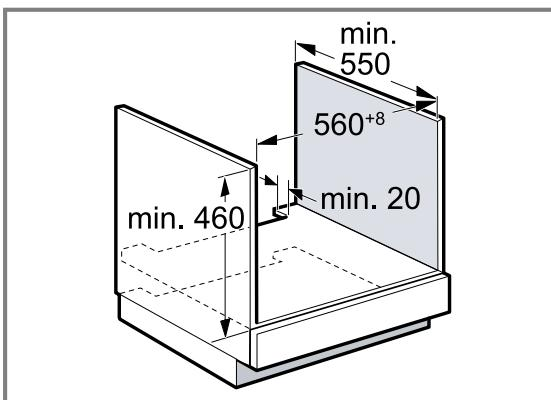
Per la ventilazione dell'apparecchio occorre una fessura di ventilazione nel ripiano intermedio.
