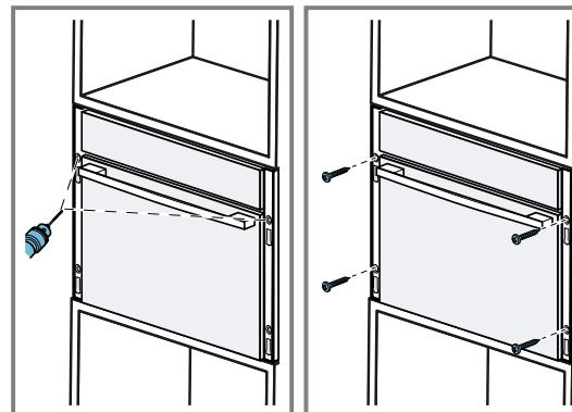
**4. Abbassare le viti di regolazione degli elementi di fissaggio.**
