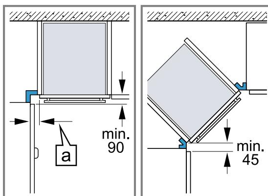
Per permettere l'apertura dello sportello, tenere conto delle dimensioni minime del montaggio angolare. La misura **a** dipende dallo spessore del frontale del mobile e della maniglia.
