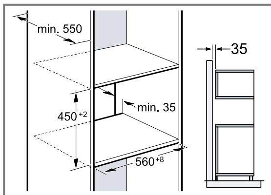
Per la ventilazione dell'apparecchio occorre una fessura di ventilazione nei doppifondi.
