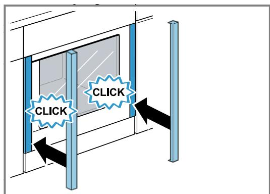
La scanalatura sui pannelli deve trovarsi in alto. Posizionare la scanalatura dei pannelli sulla relativa nervatura trasversale in corrispondenza della parte di fissaggio rossa.
