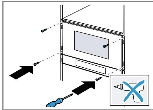
4. Abbassare le viti di regolazione degli elementi di fissaggio.
