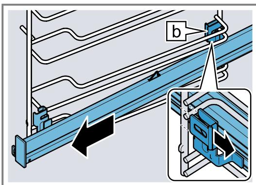
4. Die Auszugsschiene entfernen.
