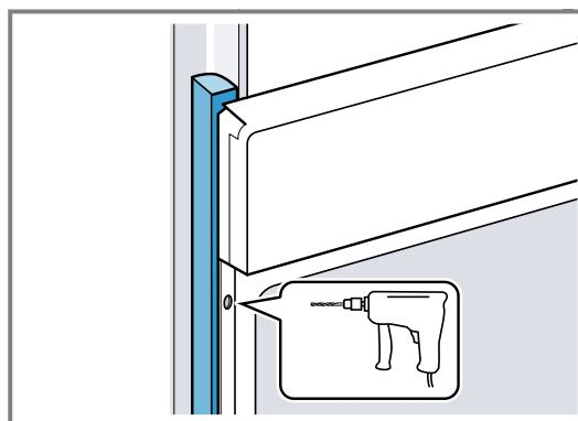
4. Das Gerät mit adäquater Schraube befestigen.
