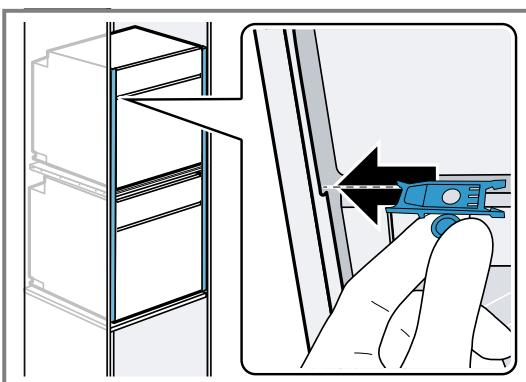
3. Das Befestigungselement nach links oder rechts drehen, um die Ausrichtung der Blenden anzupassen.
