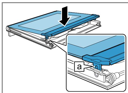
10. Die beiden Schrauben links und rechts an der Gerätetür eindrehen.
