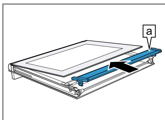
9. Die Innenscheibe mit der Halterung ⑧ in die Öffnung einsetzen.
