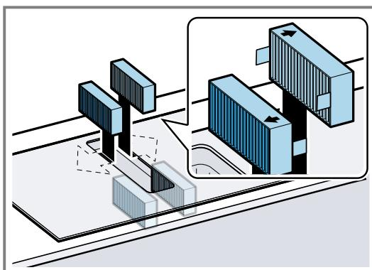
5. Den Fettfilter in das Gerät einsetzen.
