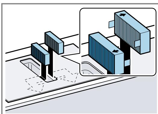
4. Die anderen GeruchsfILTER oder Akustikfilter links und rechts in das Gerät einsetzen.
