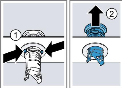
5. Unter fließendem Wasser die Siebelemente reinigen.
