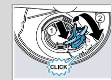
8. Montare il sistema di filtraggio.
