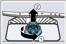
2. Ruotare il filtro grosso in senso antiorario ① e togliere il sistema di filtraggio ②.
