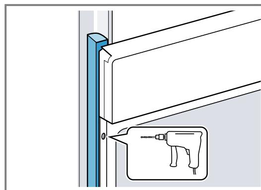
4. Das Gerät mit adäquater Schraube befestigen.
