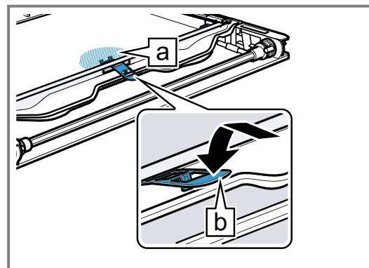
6. Die Innenscheibe so auf die Gerätetur legen, dass die Nummer **a** rechts unten lesbar ist. Die Innenscheibe schräg nach hinten in die Befestigungsschiene **b** einsetzen.
