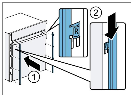
11. Die Blenden links und rechts auf Höhe der Befestigungselemente andrücken, bis ein Klickgeräusch ertönt.
