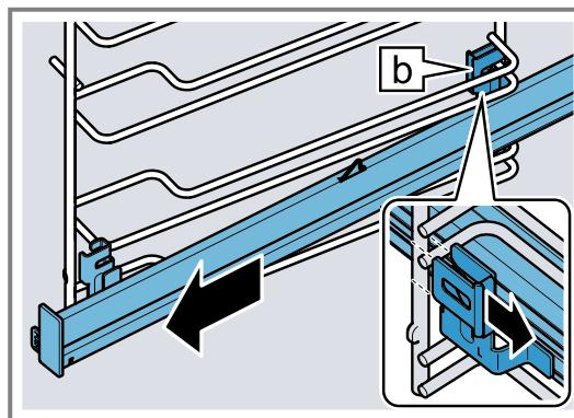
4. Die Auszugsschiene entfernen.
