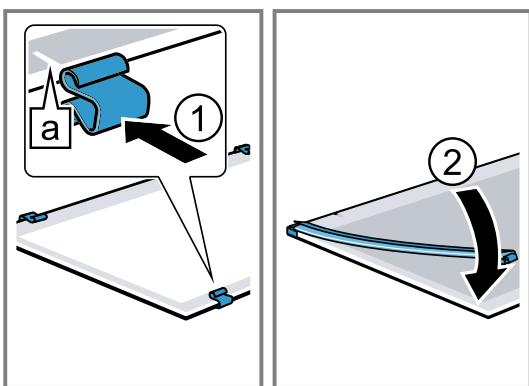
3. Die Zwischenscheibe mit Abstandshalter und Dichtungen in Pfeilrichtung einsetzen ①.
