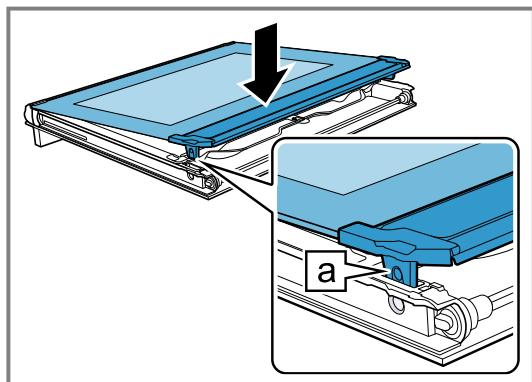
9. Die beiden Schrauben links und rechts an der Gerätetür eindrehen.
