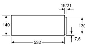
Il est possible d'installer des fours compacts d'une hauteur de 455 mm sur un tiroir. Un fond intermédiaire n'est pas nécessaire.
