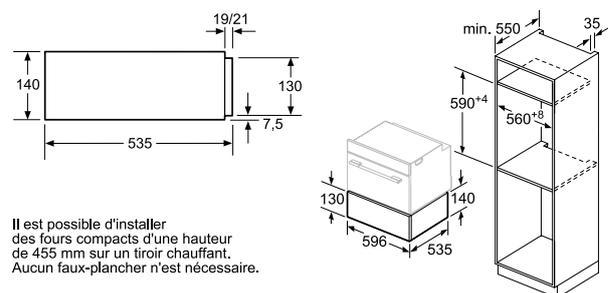
Il est possible d'installer des fours compacts d'une hauteur de 455 mm sur un tiroir chauffant. Aucun faux-plancher n'est nécessaire.
