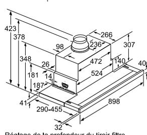
Réglage de la profondeur du tiroir-filtre possible jusqu'à 29 mm
