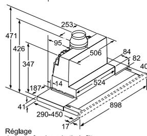
Réglage de la profondeur du tiroir-filtre possible jusqu'à 29 mm
