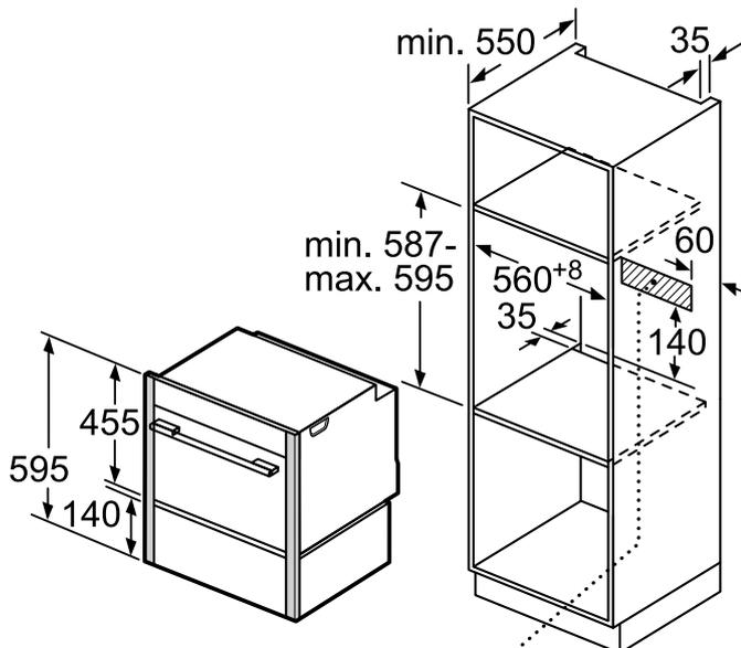
Emplacement du branchement de l'appareil
