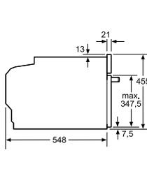
Si l'appareil compact est installé sous une table de cuisson, les épaisseurs de plaque de travail suivantes (le cas échéant y compris la sous-structure) doivent être respectées.
