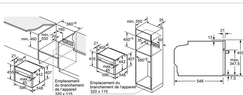
Si l'appareil compact est installé sous une table de cuisson, les épaisseurs de plaque de travail suivantes (le cas échéant y compris la sous-structure) doivent être respectées.
