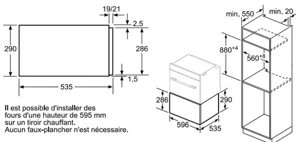
Il est possible d'installer des fours d'une hauteur de 595 mm sur un tiroir chauffant. Aucun faux-plancher n'est nécessaire.
