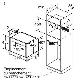
Emplacement du branchement de l'appareil 320 x 115
