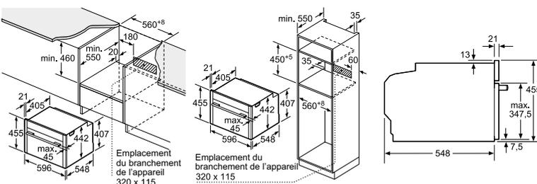
Si l'appareil compact est installé sous une table de cuisson, les épaisseurs de plaque de travail suivantes (le cas échéant y compris la sous-structure) doivent être respectées.
