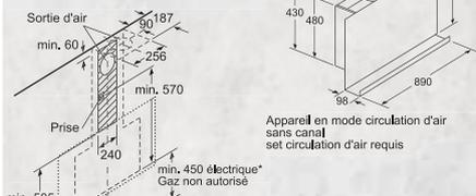
Appareil en mode circulation d'air sans canal set circulation d'air requis
