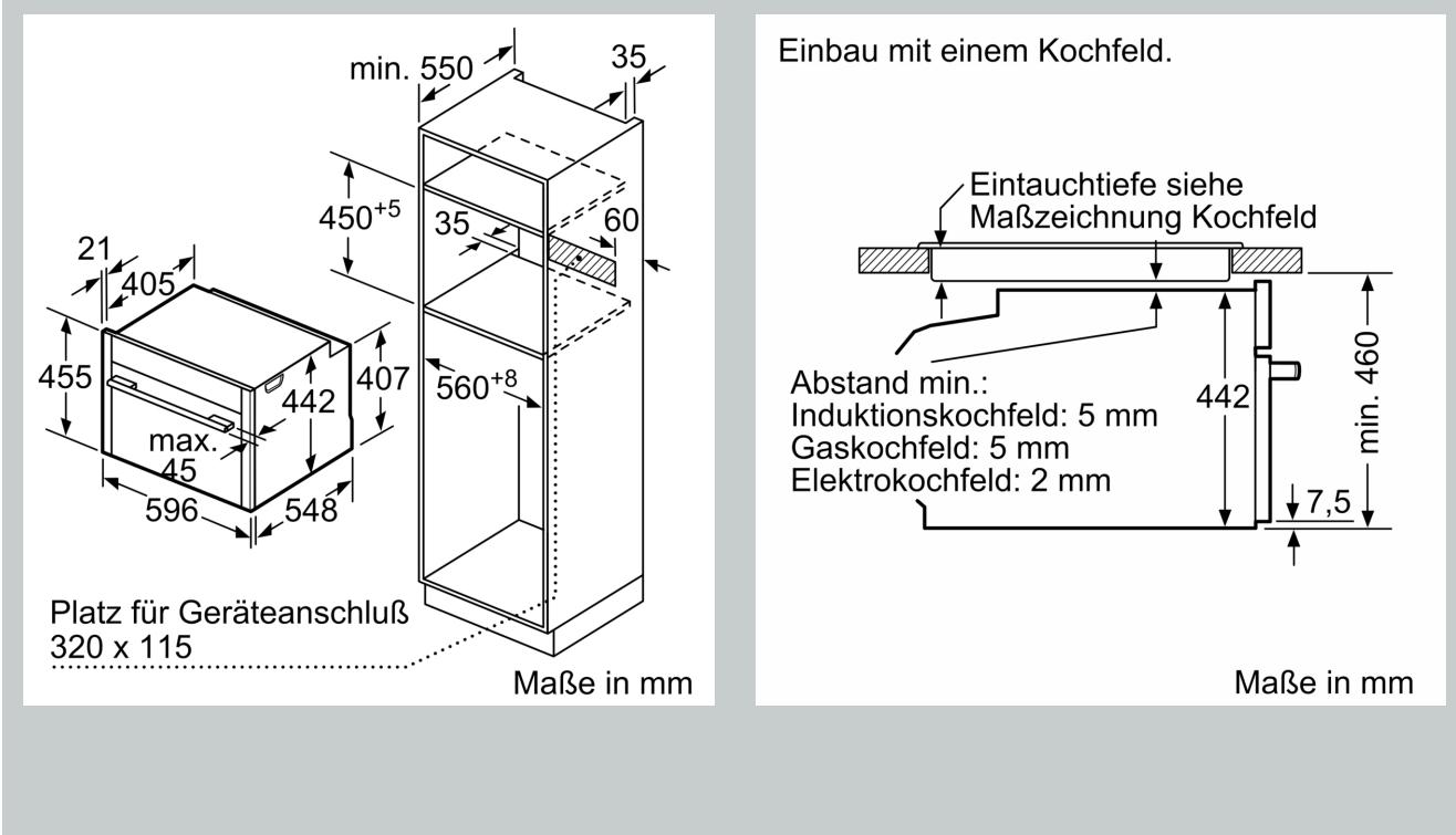
Wird das Kompaktgerät unter einem Kochfeld eingebaut, muss folgende Arbeitsplattenstärke (ggf. inkl. Unterkonstruktion) beachtet werden.
