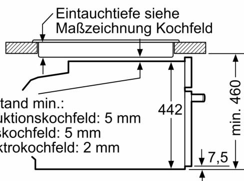
Wird das Kompaktgerät unter einem Kochfeld eingebaut, muss folgende Arbeitsplattenstärke (ggf. inkl. Unterkonstruktion) beachtet werden.
